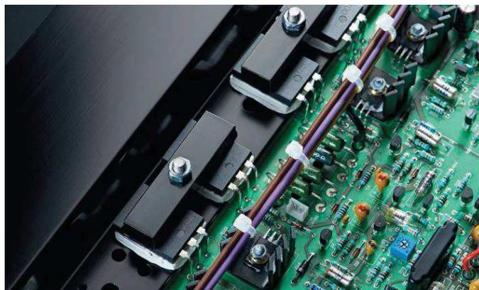
Il transistor di uscita NA009 e la circuitazione DR nell'amplificatore finale Naim NAP 300 DR
