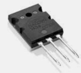
L'NA009 è il nuovo transistor di alimentazione usato nello stadio di uscita degli amplificatori finali. Usato esclusivamente sugli amplificatori Naim, NA009 ha richiesto più di un anno per lo sviluppo, con grande lavoro di scelta dei materiali, abbinamento delle dinamiche termiche – per l'effetto del calore sulle prestazioni – per assicurare la necessaria coerenza tra i singoli transistor.
